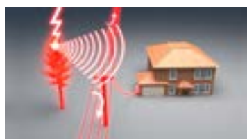
4. Попадание в соседние объекты
