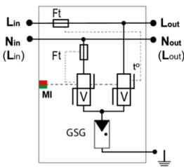
V: Варистор GSG: Специальная газовая трубка Ft: тепловой предохранитель MI: Механический индикатор состояния t\*: Отключение тепловой системы
