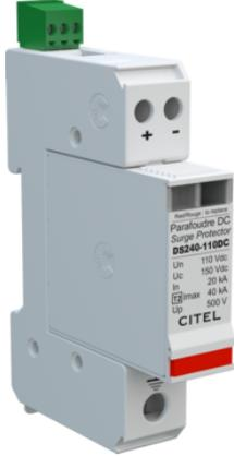
УЗИП постоянного тока - 110 В DC - Компактный -  $I_{max}$  : 40 кА - Сменный модуль - Дистанционная сигнализация - Очень низкий уровень защиты  $U_p$
