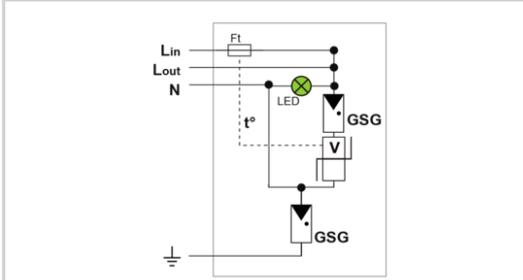
V: Варистор Ft: тепловой предохранитель GSG: Специальная газовая трубка LED: индикатор состояния t°: Отключение тепловой системы
